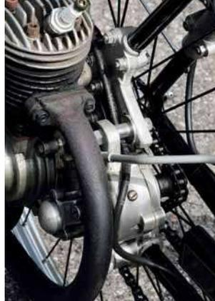
• Il tubetto della miscela deve compiere un lungo tragitto per giungere al carburatore dal serbatoio (sotto). Nelle foto a fianco si vedono anche l'ingresso del comando cambio nel basamento e la targhetta con i dati identificativi applicata al piccolo magnete.
