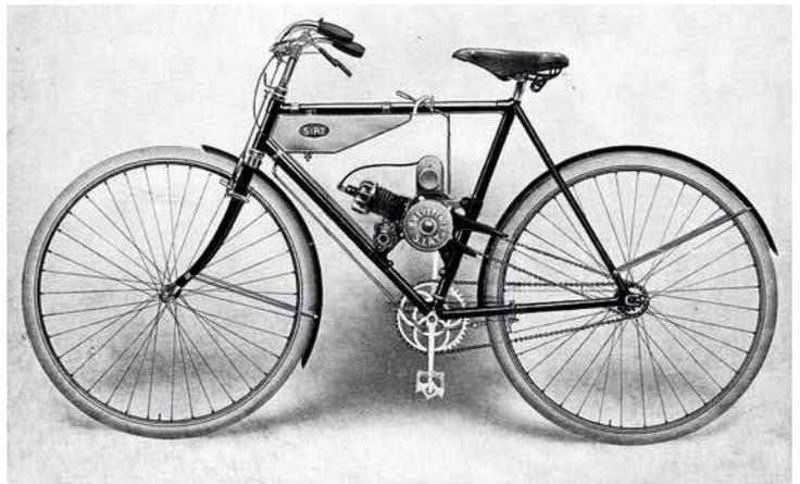
• Due esemplari della produzione italiana anni Venti, l'ELSA montato lateralmente e il SIAT applicato invece al centro del telaio. Entrambi due tempi monomarcia con trasmissione finale a catena.
